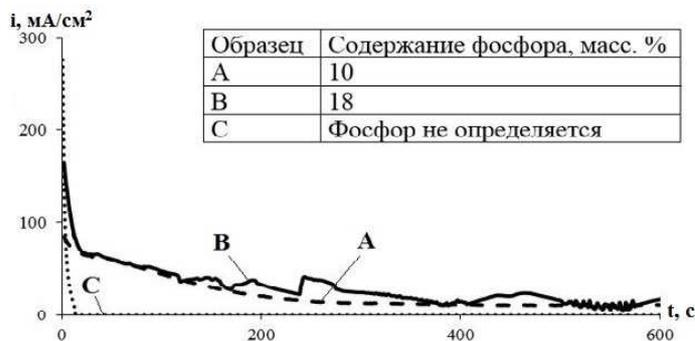
Рис. 2а. Транзиенты плотностей тока образцов: А (-100 мВ), В (100 мВ), С (300 мВ) в растворе  $\text{NaH}_2\text{PO}_4$  (1,2 моль/л; рН 3,5)
