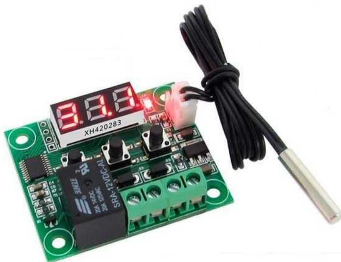
Рис. 2. Внешний вид электронного термостата
